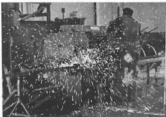
Smeltzaagmachine; voor het zagen van metalen. Deze zaagmachine is voorzien van een wolfram-molybdeenschijf. Deze schijf heeft een doorsnede van 550 mm. en draait met een snelheid van 2900 toeren per minuut. Door de grote omtreksnelheid smelt het te zagen materiaal. De schijf is van tanden voorzien, die het gesmolten materiaal verwijderen wat een prachtige vonkenregen veroorzaakt. Om u een indruk te geven van de capaciteit van deze zaag; een balk van U.N.P. 200 mm. wordt in 12 seconden doorgezaagd.
