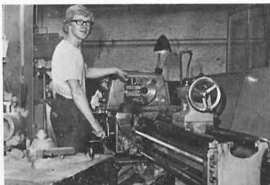
Dhr. Martin Saanen is draaier aan de kleine draaibank. Hij is op deze plaats gekomen, nadat hij zijn opleiding heeft gehad in onze bedrijfsschool. De kleine draaibank is bedoeld voor het normaal draaiwerk van kleine onderdelen.
